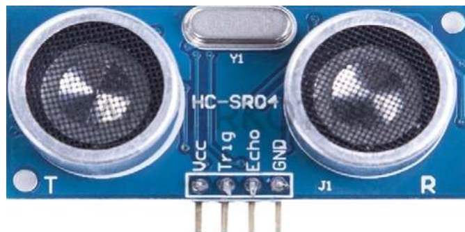
Рис. 16. Ультразвуковой датчик (дальномер)
