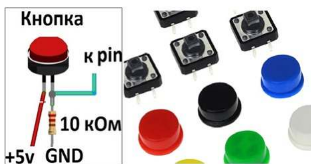
Рис. 1. Схема подключения тактовой кнопки к микроконтроллерной плате
