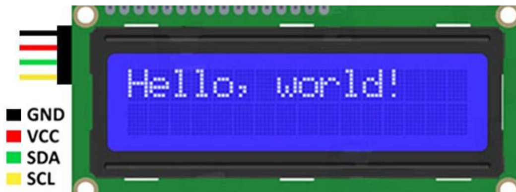
Рис. 1. Подключение модуля ЖКИ к Ардуино
