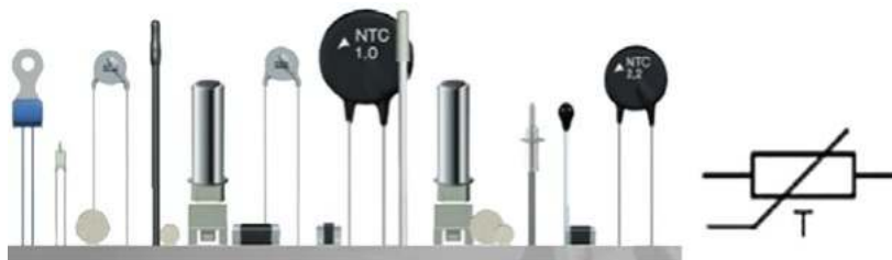
Рис. 11. Терморезисторы и их обозначение
