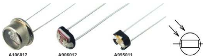
Рис. 12. Фоторезисторы и их обозначение
